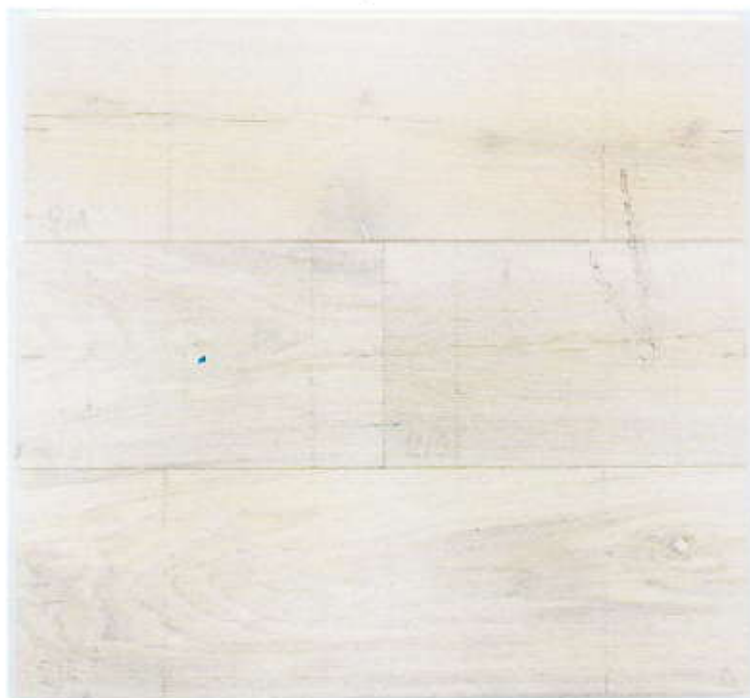
Fotografie 2 Sestava zkušební vzorku č. 13/14-2 (po dokončení zkoušky)
